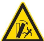
**Gefahr:** Defekte oder fehlende Stützbeine können dazu führen, dass der Wechselbehälter beim Absetzen kippt und schwere Unfälle entstehen.
