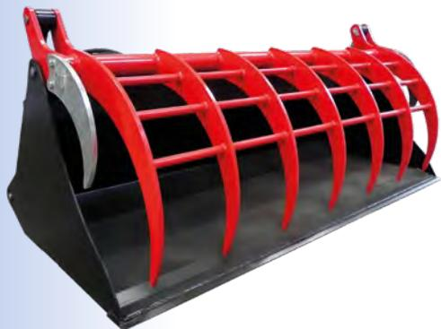
Mit **LP-Aufnahme für Front-, Teleskop- oder Radlader** (Adapterplatten bitte separat bestellen), mit gehärteter Schürfkante 500 HB, Schaufelunterseite mit Gleitkufen, mit großzügig dimensionierten Hydraulikzylindern, Stecker BG3.
