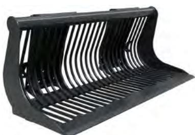
Mit **LP-Aufnahme für Hoflader** (Adapterplatten bitte separat bestellen), Schürfschiene aus gehärtetem Stahl, zusätzliche Verschleißschiene im Schaufelboden, 20 mm Rundstäbe mit einem Abstand von 40 mm, dickwandiges Tragrohr und stabile Seitenbleche.
