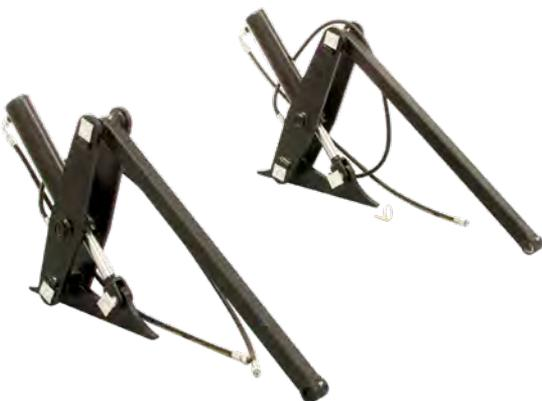
**Vollhydraulische Nachrüstätze für Frontlader**, Kippwinkel bis 180°/ Hubweg 850 mm, Druck je Zylinder 3.450 daN bei 180 bar, Zug je Zylinder 2.300 daN bei 180 bar, mit Hydraulikschläuchen.
