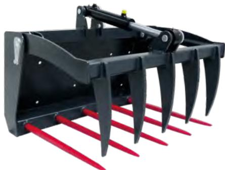
Mit **LP-Aufnahme für Hoflader** (Adapterplatten bitte separat bestellen), Verschleißblech unter dem Zinkenträger, inkl. Hydraulikschläuchen und -steckern BG3, geschmiedete Zinken (800 mm), Querrohr an der Oberkante.
