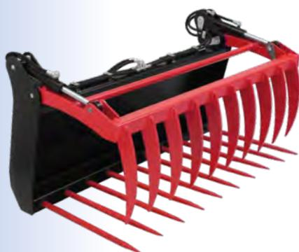
Mit **LP-Aufnahme für Front-, Teleskop- oder Radlader** (Adapterplatten bitte separat bestellen), Verschleißblech unten, schraubbare geschmiedete Zinken mit 900 mm Länge, dickwandige Seitenbleche, Stecker BG3.
