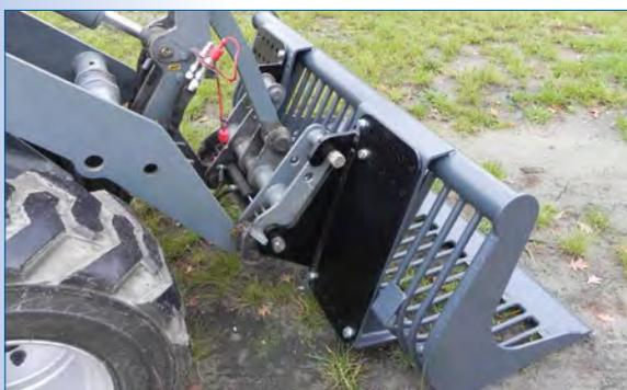
Mit der Lochplatten (LP)-Aufnahme lassen sich die gängigen Front-, Rad-, Teleskop- oder Hoflader mit unserem Anbaugerät kombinieren.
