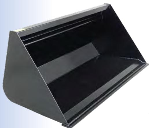
Mit **LP-Aufnahme für Front-, Teleskop- oder Radlader** (Adapterplatten bitte separat bestellen), konische Bauart für besseres Abrutschen des Schüttgutes, gehärtete Schürfkante 500 HB, Schaufelunterseite mit Gleitkufen.
