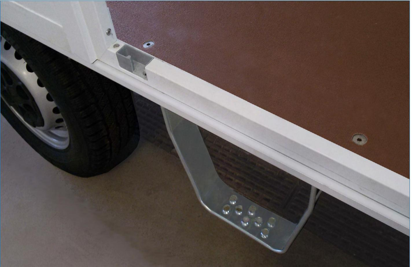
Für die einfache Montage des im Bausatz mitgelieferten **Seitenaufstiegs** MA 200373 entfernen Sie zunächst die Muttern und Scheiben im Bereich der Seitentür.
