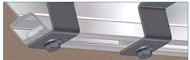
**Die optionalen Kotflügelhalter (für alle gängigen Kotflügel geeignet) sind an den Querträgern des Unterbaus vormontiert.**
