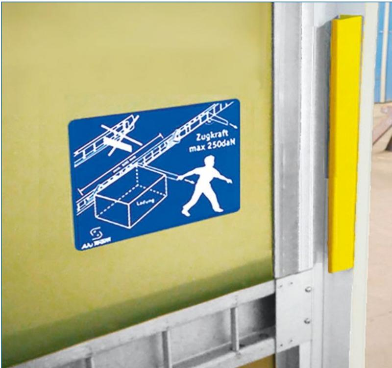
Minutenschnell ist der mitgelieferte Handgriff mittels der beigefügten selbstbohrenden Befestigungsschrauben angebracht.
