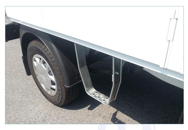
Für die einfache Montage des im Bausatz mitgelieferten **Seitenaufstiegs** MA 200373 entfernen Sie zunächst die Muttern und Scheiben im Bereich der Seitentür.
